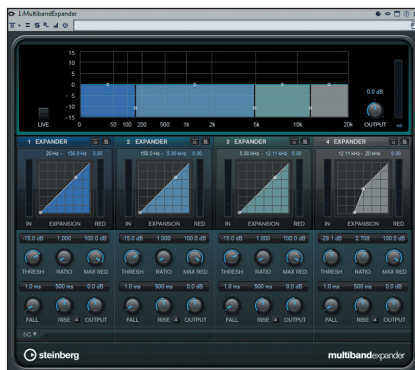
fig. 9.3 Expander multi banda per noise reduction sulle alte frequenze
