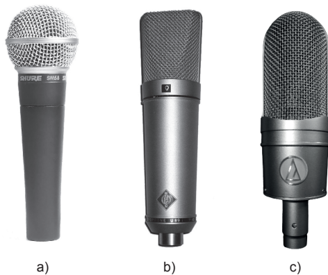
fig. 6.7: a) microfono dinamico; b) microfono a condensatore; c) microfono a nastro
