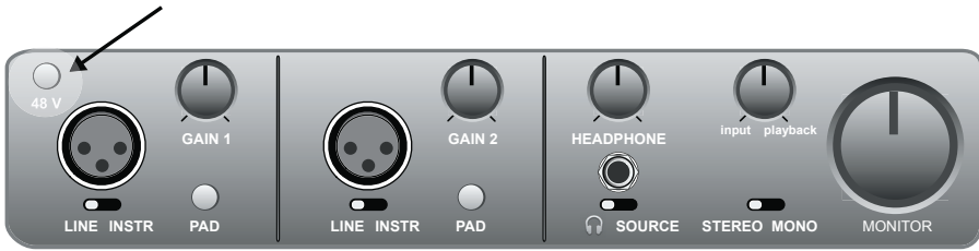
fig. 6.1: interruttore dell'alimentazione phantom su una scheda audio esterna
